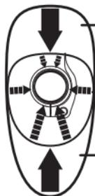
ungleichmäßige Kräfteinwirkung auf das Führungsrohr der Stütze.
